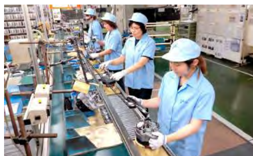
オルタネータ組み立てライン
