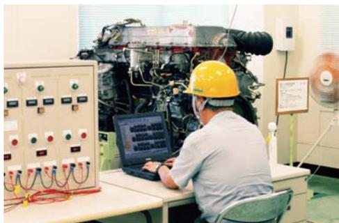
大型トラック用エンジンでのスタータ信頼性評価試験
