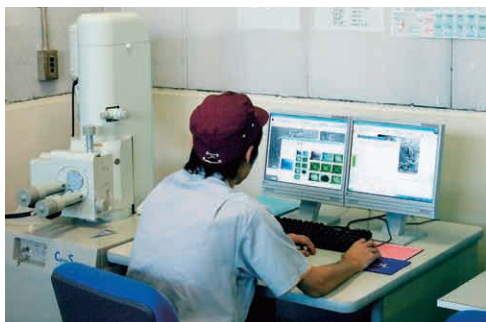
電子顕微鏡による評価部品のミクロ観察
