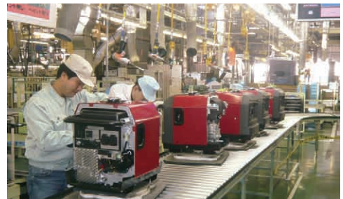
発電機組み立てライン
