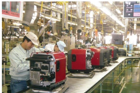
発電機組み立てライン
