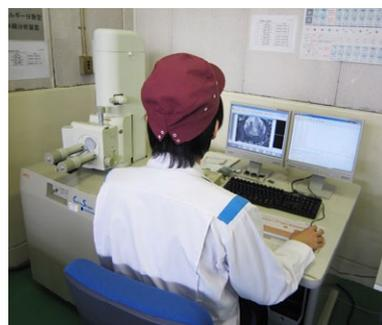
電子顕微鏡(SEM)による評価部品のミクロ観察
