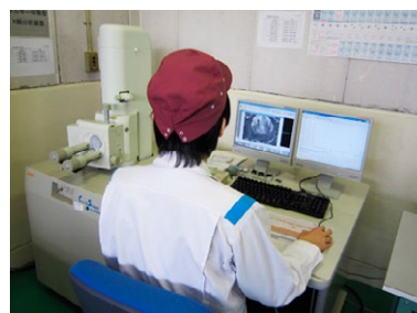
電子顕微鏡(SEM)による評価部品のミクロ観察
