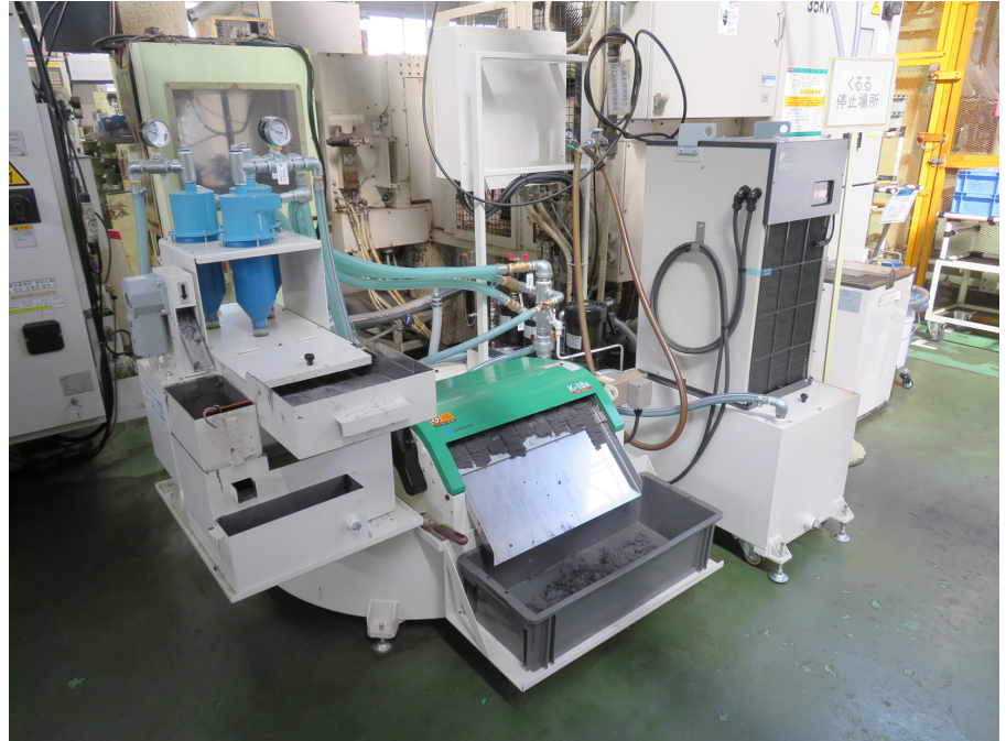
NC研磨機：サイクロン式クーラントタンク
