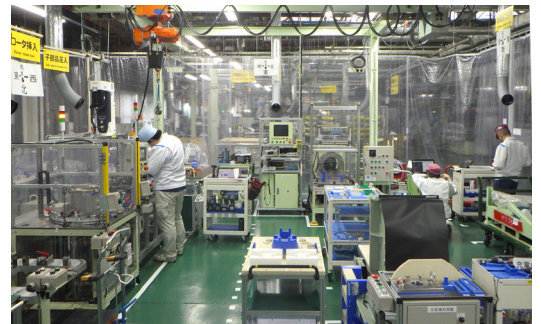
EVモーター組立ライン
