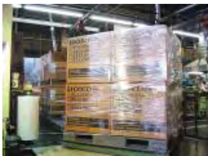
サワフジ製品の荷造り梱包用ストレッチフィルムの巻数を8巻から5巻に改善しました
